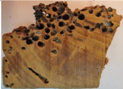
Figura 11 – Madeira atacada por Tereidos
