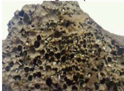
Figura 13 – Madeira agredida por Martesia striata
