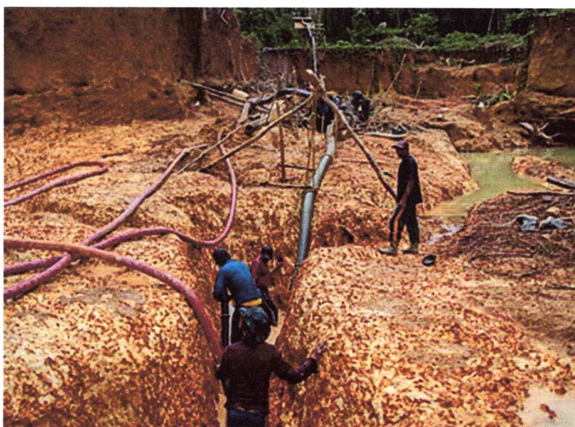
Figura 1 – Garimpeiros em escavação com mangueira. Fonte: < https://valor.globo.com/brasil/noticia/2020/05/21/preco-do-ouro-em-alta-atrai-extracao-em-area-florestal.ghtml > (2020).
