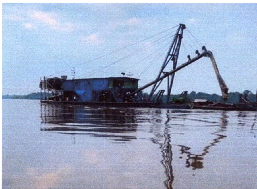
Figura 2 – Dragagem escariante no rio Tapajós. Fonte: Arquivo pessoal, Rocha (2021).
