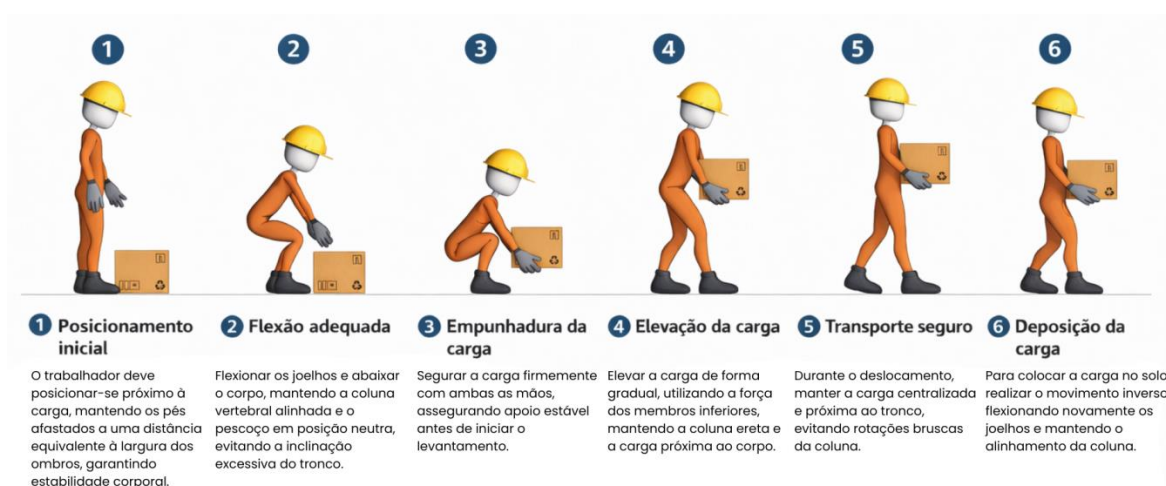
Figura 5 - Técnica correta para o levantamento manual de cargas. Fonte: Autores (2026).
