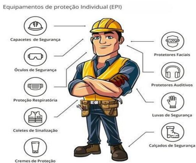
Figura 3 – Exemplos de Equipamentos de Proteção Individual (EPIs) utilizados na Construção Civil. Fonte: Manuttech (2024).
