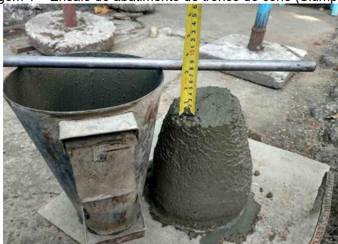
Imagem 1 – Ensaio de abatimento de tronco de cone (Slump Test)
