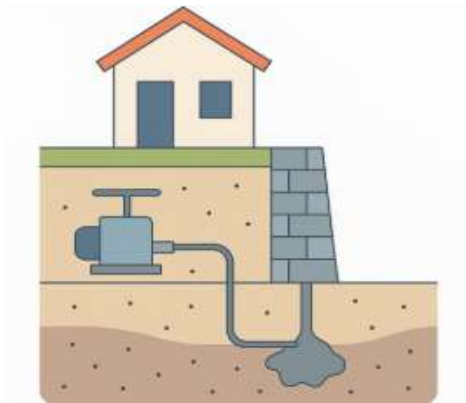
Figura 23 - Injeção de calda de cimento. Fonte: Próprio autor (2025).
