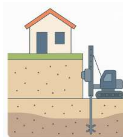
Figura 24 - Implantação de micro estacas. Fonte: Próprio autor (2025).
