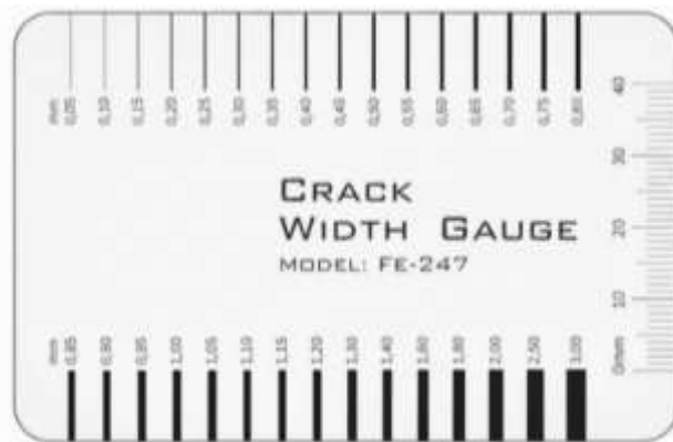
Figura 18 - Exemplo de régua de monitoramento de fissura, com escala milimétrica. Fonte: Próprio autor (2025).
