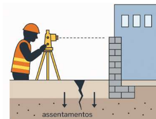
Figura 19 - Monitoramento topográfico. Fonte: Próprio autor (2025).
