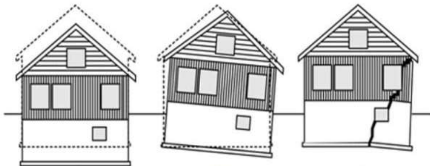
Figura 9 - Tipos de recalque. Fonte: E-Civil (2022).
