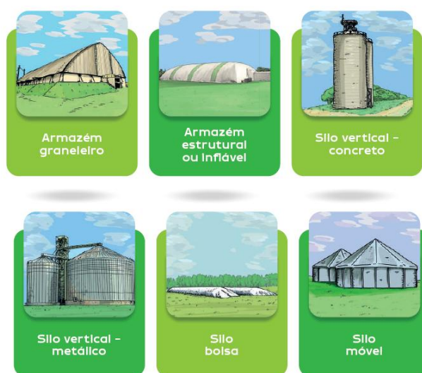
Figura 6– Tipos de armazéns para estocagem de grãos sólidos agrícolas. Fonte: Péra et al. (2024).
