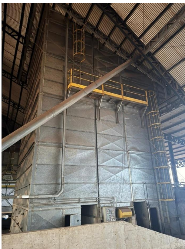
Figura 13- Secador de grãos utilizado no armazém. Fonte: Dados da pesquisa de campo (2026).
